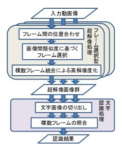
図 2 提案手法の処理の流れ
